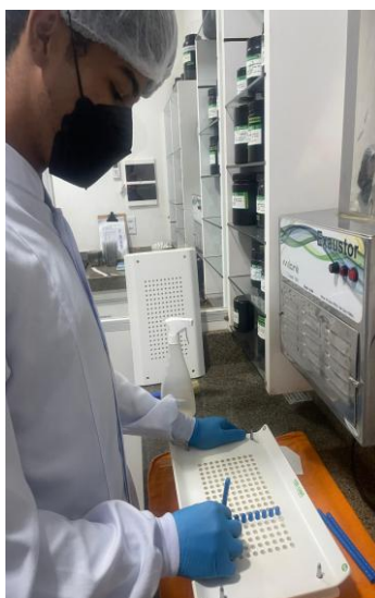
Figura 5: Distribuição e inserção das cápsulas na encapsuladora.
