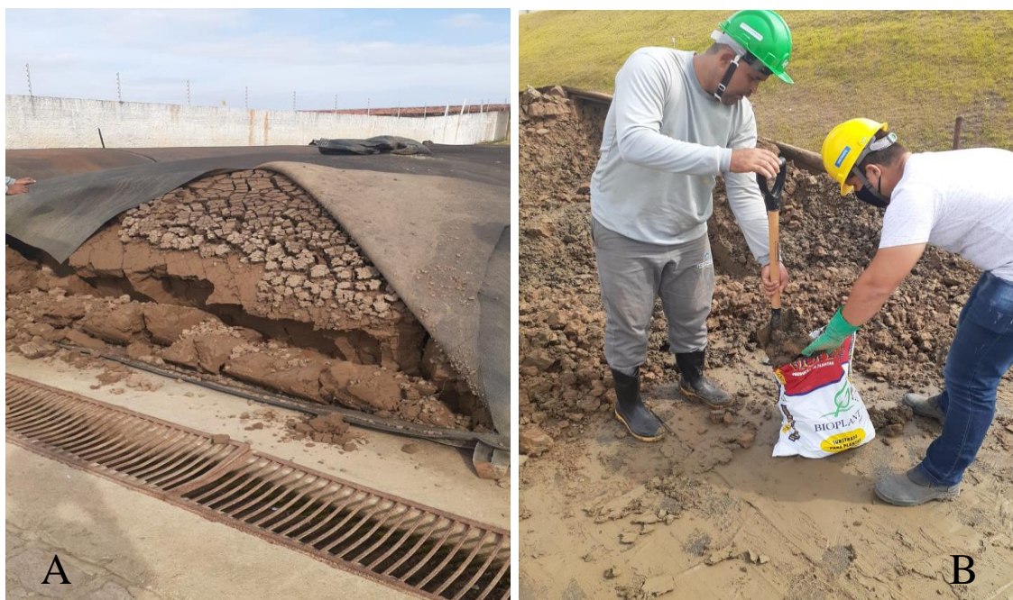
Figura 2. Coleta de amostras de lodo na Estação de Tratamento de Água (Figuras A e B).
