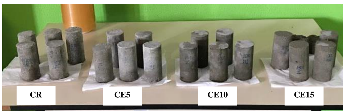
Figura 12 – Corpos de prova antes o ensaio de resistência à compressão
