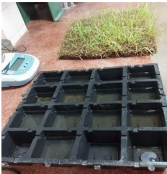
Figura 13 - Acúmulo de água na amostra do IFAL - Campus Maceió.
