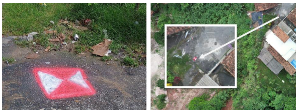
Figura 29: Alvos artificiais para identificação durante plano de voo.
