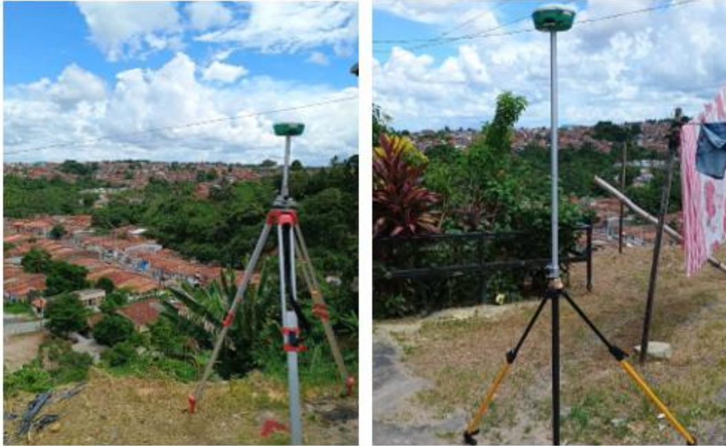
Figura 24: Levantamento GNSS – Levantamento geodésico dos pontos P3 e P4
