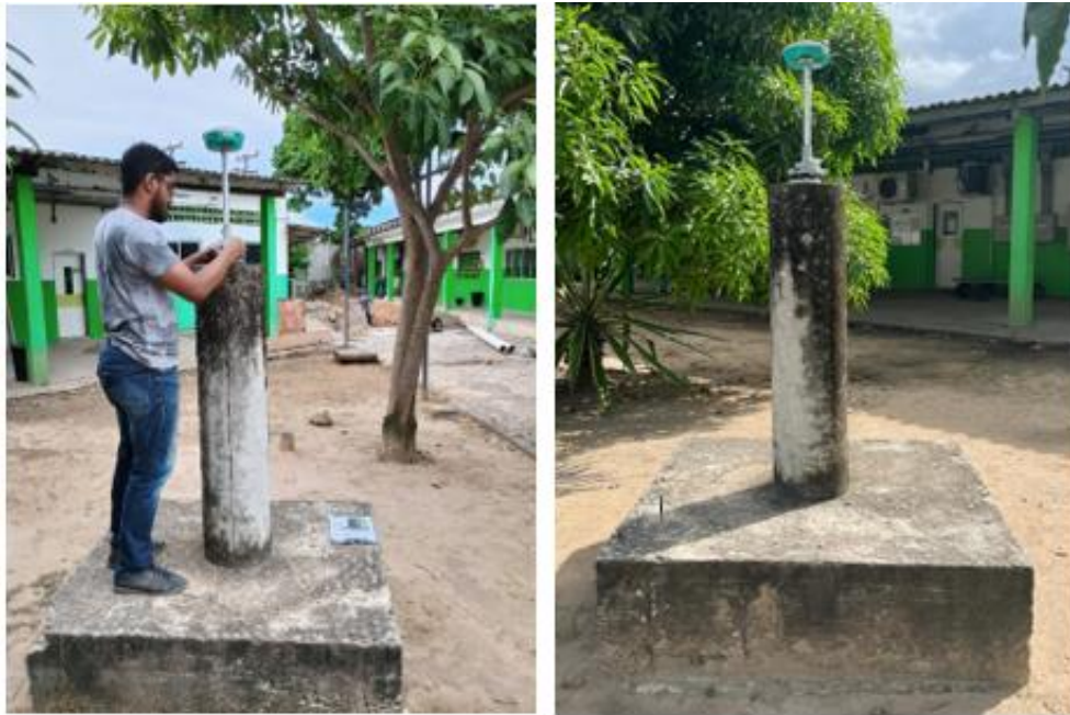
Figura 22: Levantamento GNSS receptor Base, Marco geodésico IFAL001 (Ponto Base)
