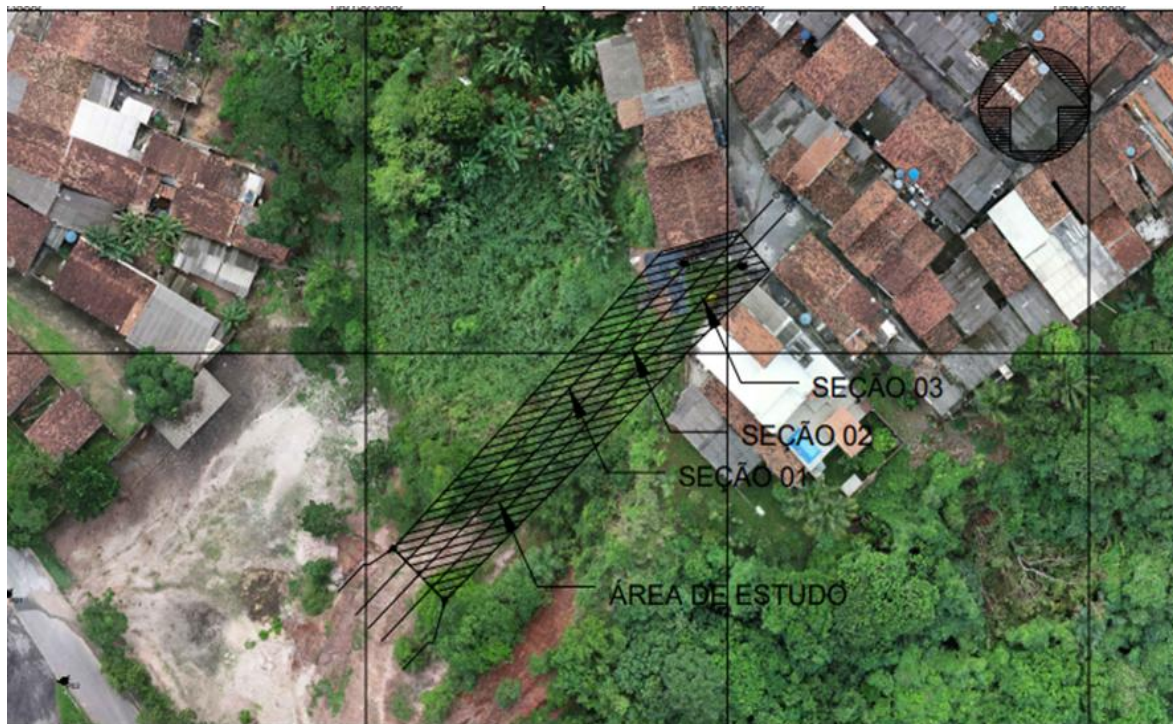
Figura 40: Criação das seções do talude.
