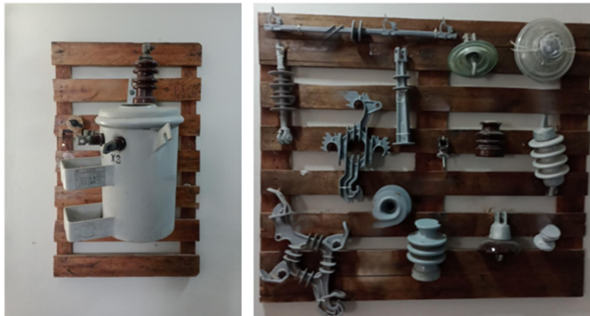
Figura 03 – Transformador monofásico e equipamentos para montagem de RD.
