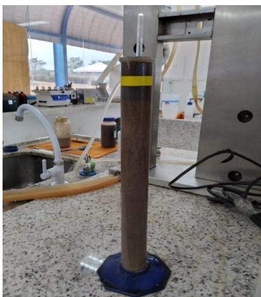
Figura 32: Análise no sacarímetro de brix.
