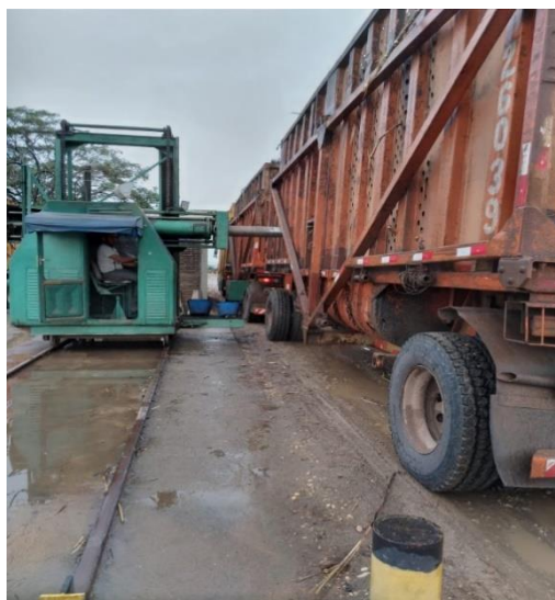
Figura 4: Amostragem com sonda mecânica horizontal.
