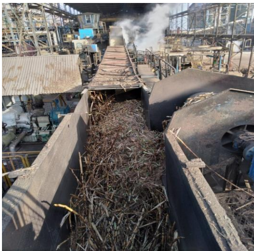
Figura 16: Mistura da cana inteira e picada na esteira metálica.
