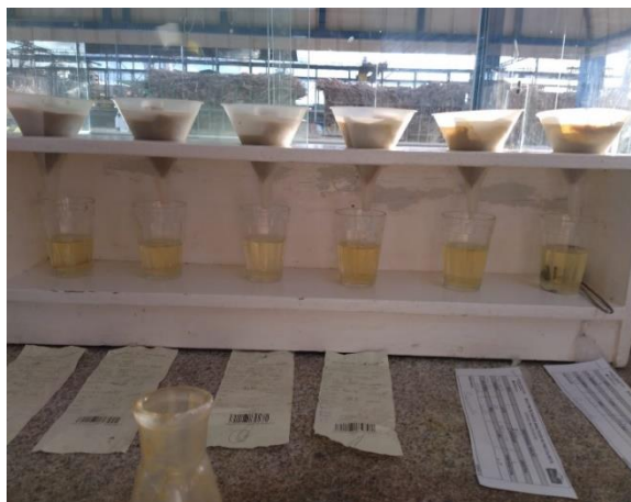
Figura 11: Clarificação do caldo.
