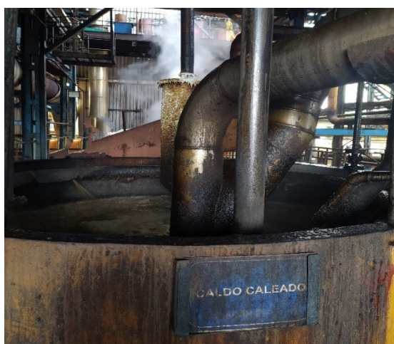
.Figura 8: Tratamento de caldo com leite de Cal e sulfitação com dióxido de Enxofre \text{SO}_2 na Usina Caeté - Unidade Marituba.
