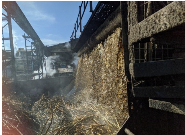
Figura 4: Lavagem de cana-de-açúcar na Usina Caeté - Unidade Marituba.
