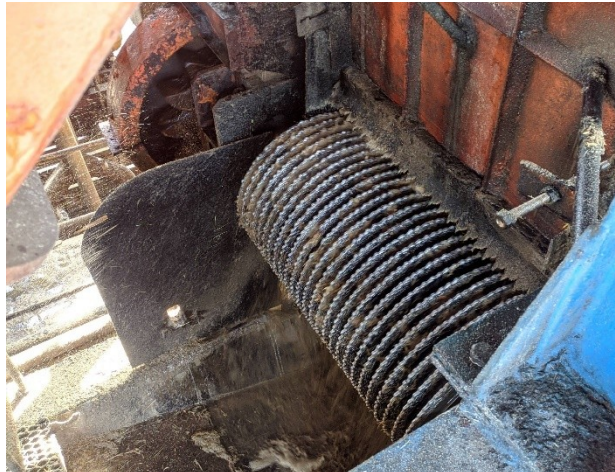
Figura 6: Rolo triturador da moenda na Usina Caeté - Unidade Marituba.
