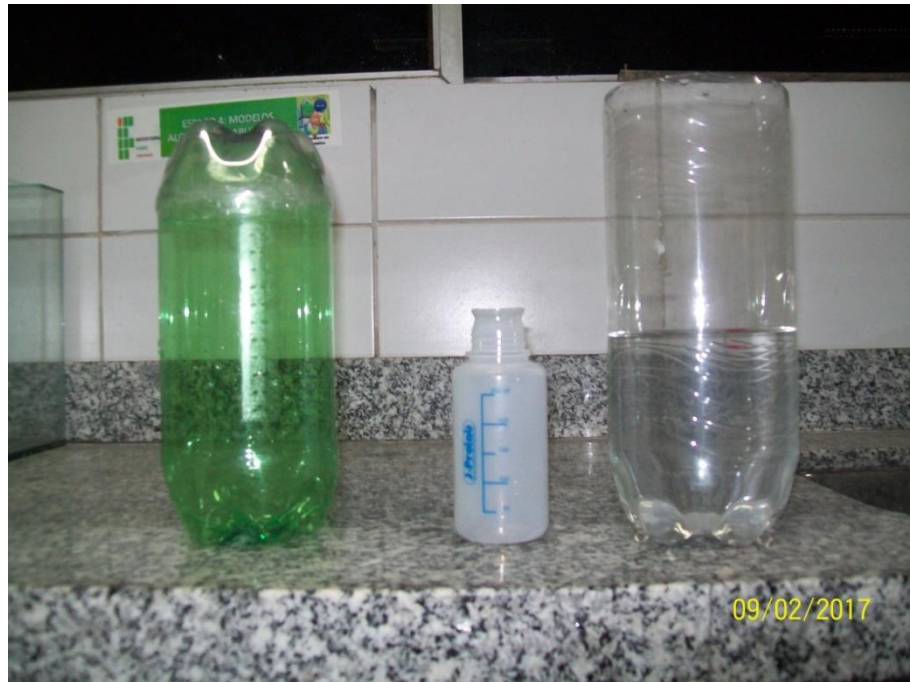
Figura 8: Balança Hidráulica em seu estágio final de construção.
