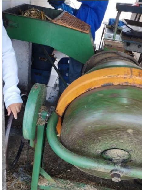
Figura 4. Homogeneização da amostra através de betoneira.
