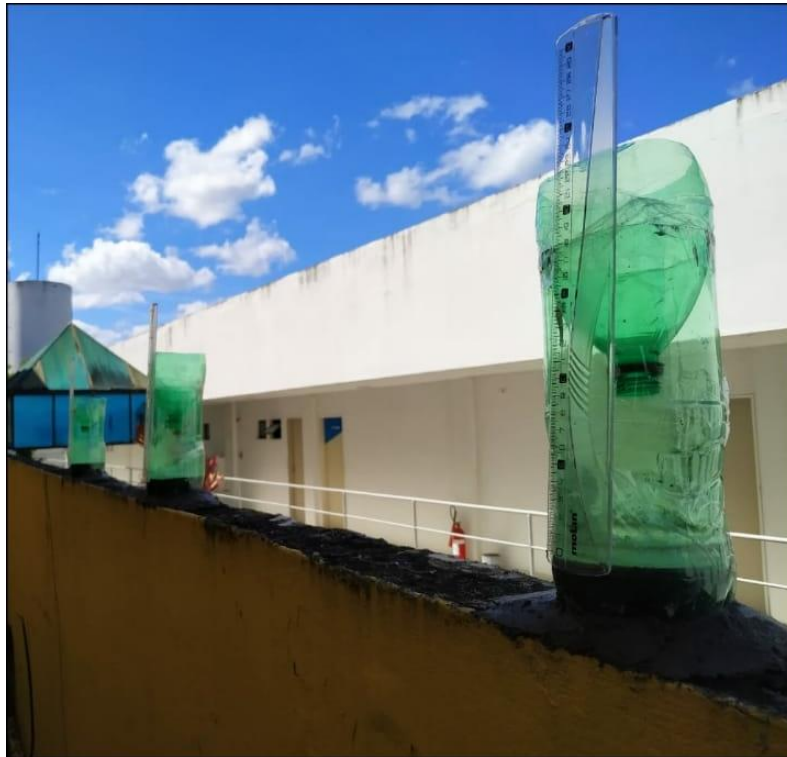
Figura 3 – Instalação do Pluviômetro Caseiro.
