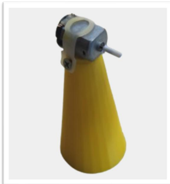
Figura 21 - Fixação do motor DC à base do microaerogerador.
