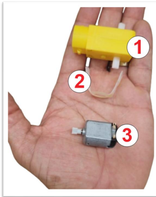
Figura 20 - Motor DC 3-6V 16.000 rpm com caixa de redução 1:50.
