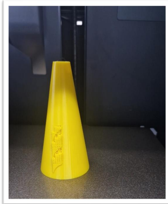
Figura 17 - Torre de sustentação do microaerogerador finalizada.
