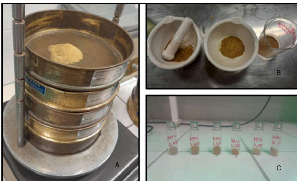
Figura 20. Processo de separação granulométrica no tamisador com peneiras de 16 a 100 mesh (A); processo contínuo de maceração (B); e pó das três variedades de manga acondicionado em frascos de conservação (C).
