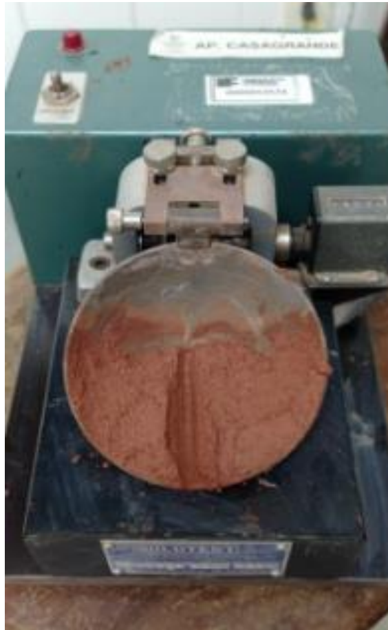
Figura 7: Realização do ensaio de LL no aparelho de Casagrande.
