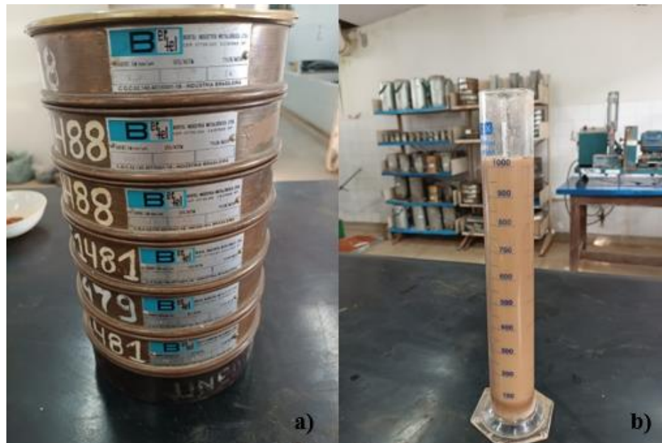
Figura 6: Realização do ensaio de granulometria: a) Peneiras para peneiramento; b) Medição da densidade no ensaio de sedimentação.
