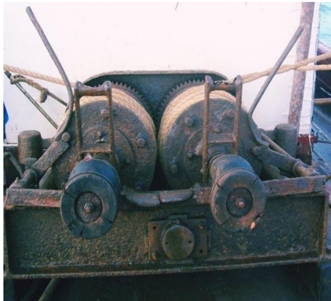
Figura 6: Guincho utilizado na embarcação camaroeira do Pontal do Peba-AL. Fonte: Autores.
