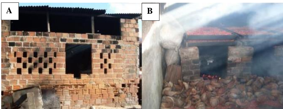
Figura 5. A – Construção utilizada para defumação de camarões no Pontal do Peba; B – Camarões sendo defumados com a utilização de cascas de cocos como fonte de combustão. Fonte: Autores.
