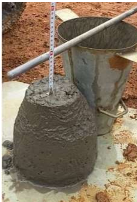
Figura 10 – Ensaio de abatimento de tronco de cone executado em canteiro de obra
