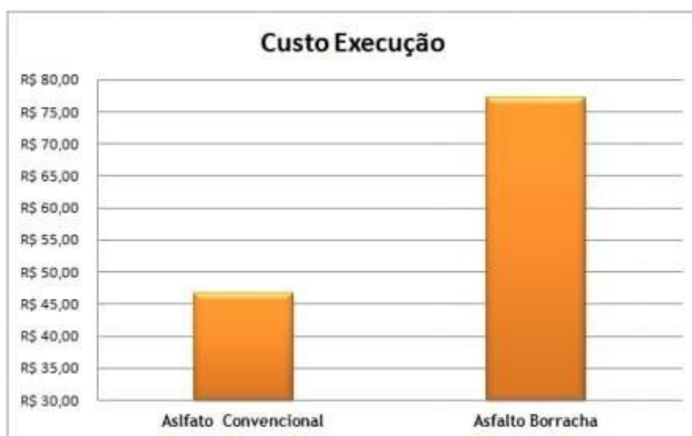
FIGURA 2: CUSTO DE EXECUÇÃO- AVALIAÇÃO DA VIABILIDADE FINANCEIRA DE PROJETOS COM UTILIZAÇÃO DO ASFALTO-BORRACHA EM RELAÇÃO AO ASFALTO CONVENCIONAL
