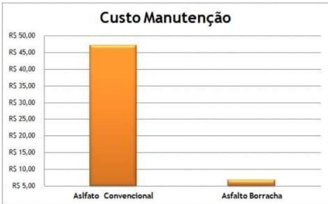
FIGURA 3: CUSTO DE MANUTENÇÃO - AVALIAÇÃO DA VIABILIDADE FINANCEIRA COM UTILIZAÇÃO DO ASFALTO - BORRACHA EM RELAÇÃO AO ASFALTO CONVENCIONAL
