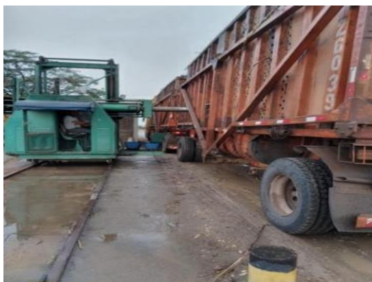
Figura 4. Amostragem com sonda mecânica horizontal.
