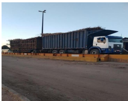
Figura 2 a. Pesagem do caminhão com a carga ao chegar na indústria.
