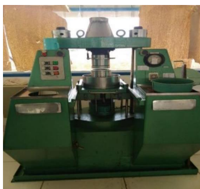
Figura 8. Prensa Hidráulica utilizada para separar o caldo do bagaço.
