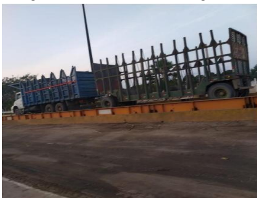
Figura 2 b. Pesagem do caminhão sem a carga ao sair da indústria.
