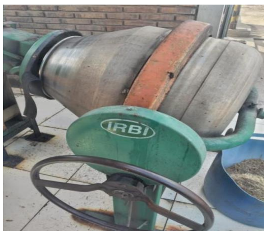
Figura 6: Forrageira e Betoneira utilizadas para facilitar a extração do caldo.
