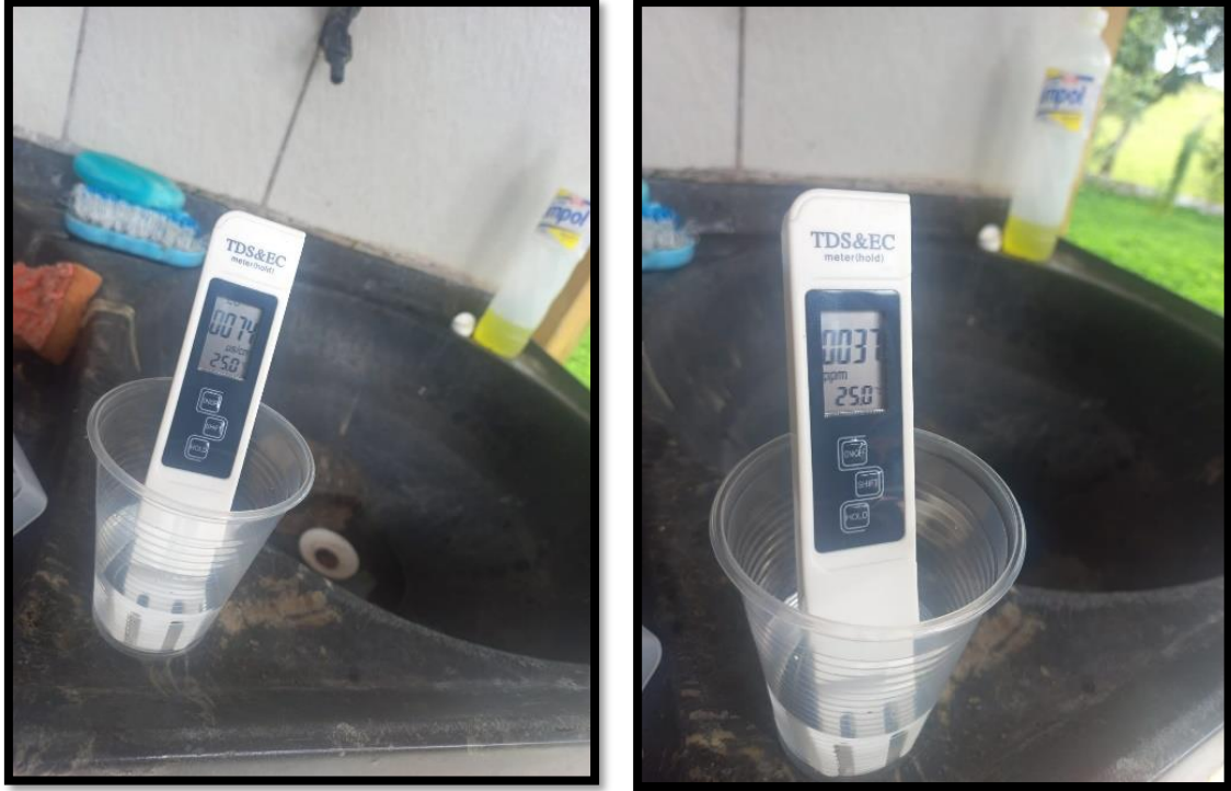
Figura 8. (A) Medidor de Sólidos Totais Dissolvidos; (B) – Eletrodo do Medidor para verificação de material sólido dissolvido na amostra de água coletada.
