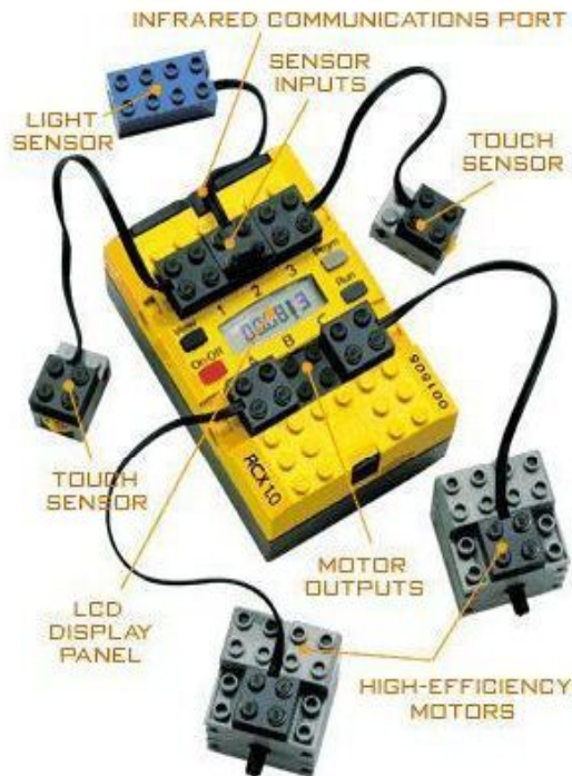
Figura 6 – Módulo RCX, responsável por processar os comandos de programação
