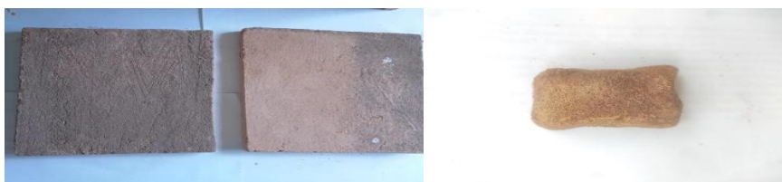
Fotos 10 e 11 – Placas Impermeabilizadas com Óleo de Soja Usado
