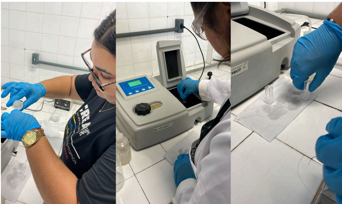
Figura 1 - Análise da absorvância com auxílio do espectrofotômetro, no laboratório de Química do IFAL - Campus Maceió.
