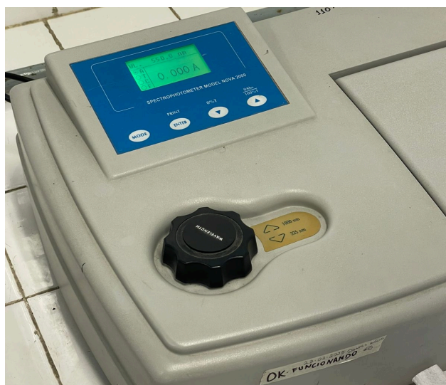
Figura 13 - Espectrofotômetro NOVA 2000 com o comprimento de onda ajustado para 550,0 nm.
