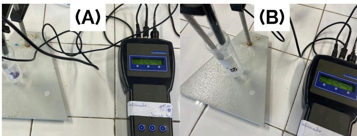
Figura 28 - Análises laboratoriais da condutividade elétrica, (A) - B02'' e (B) - B07''
