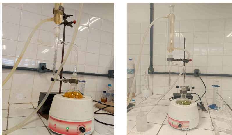
Figura 9 - Hidrodestilação com aparelho de Clevenger utilizado na extração dos OEs de tangerina (à esquerda) e limão (à direita)
