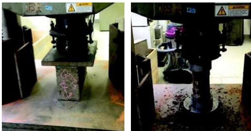
Figura 24 – Ensaio de resistência à compressão simples: Bloco de vedação (a) e corpo de prova (b)
