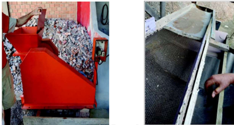
Figura 20 – Triturador de resíduos e peneira manual
