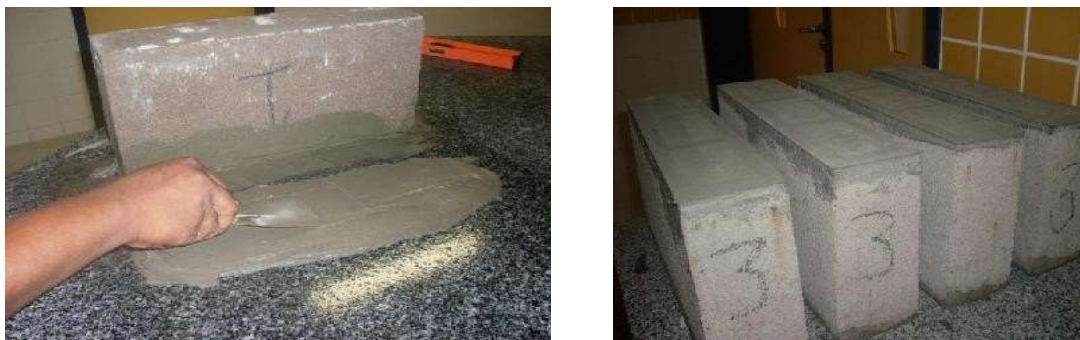
Figura 11 – Preparação da pasta de cimento e blocos de argamassa capeados
