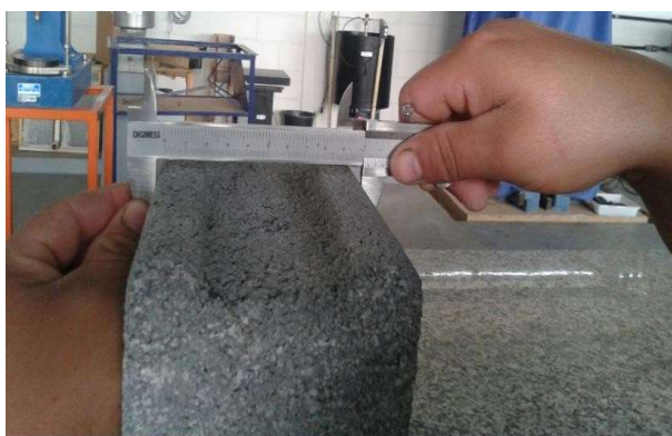
Figura 15 - Verificação das dimensões do bloco de concreto.
