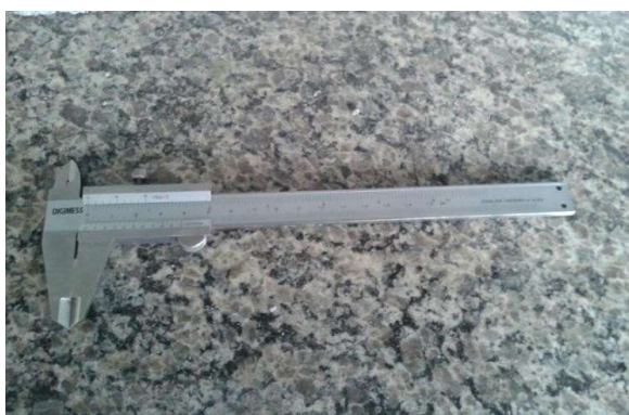
Figura 13 - Paquímetro utilizado para aferição dos blocos de concreto
