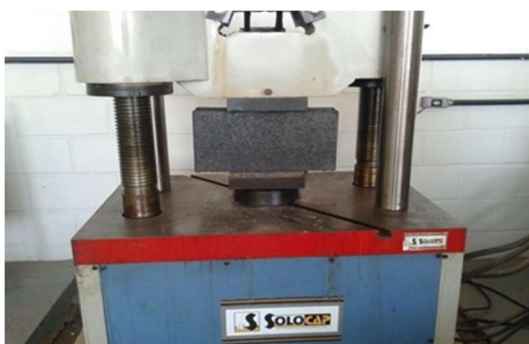
Figura 18 - Bloco de concreto no ensaio de resistência à compressão
