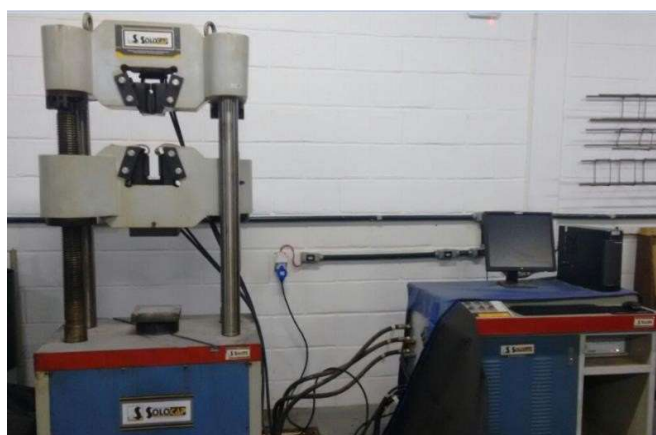
Figura 14 - Prensa hidráulica utilizada para a compressão dos blocos
