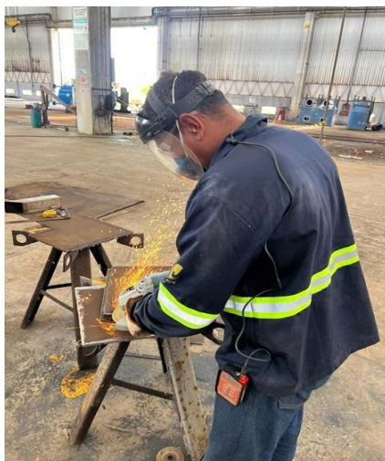
Figura 2 - Avaliação quantitativa de ruído durante a operação de corte metálico com esmerilhadeira.
