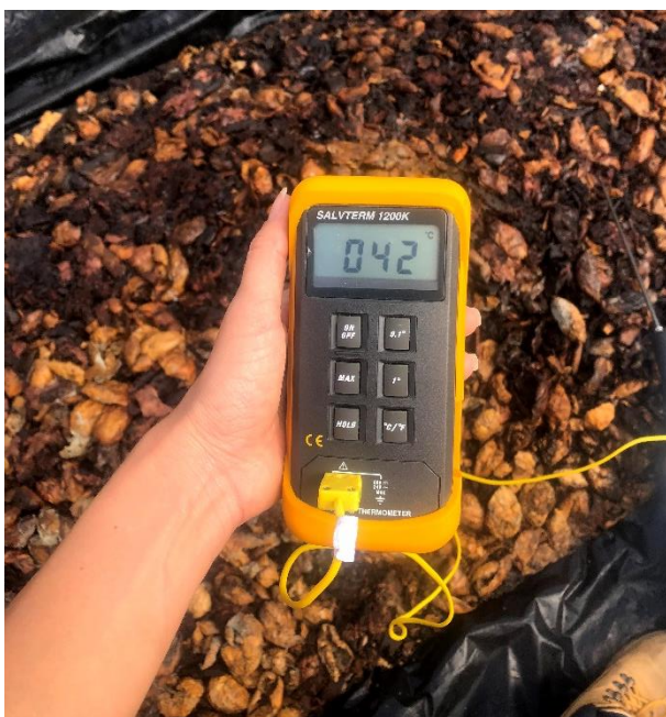
Figura 6 – Medição da temperatura com termômetro digital Salvterm 1200K
