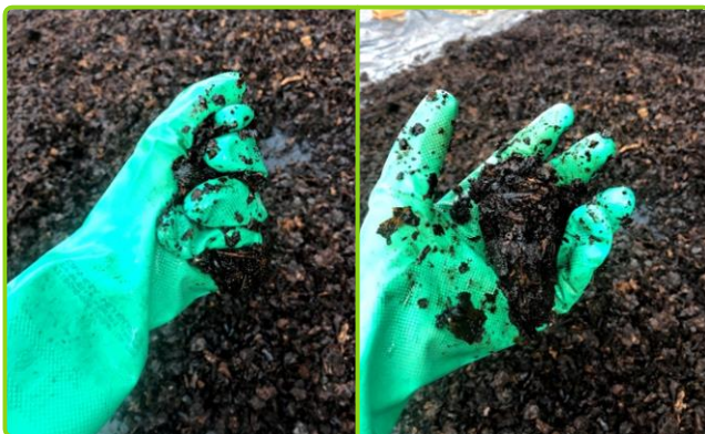
Figura 10 - Teste do teor de umidade. Tays Vasconcelos, 2021.
