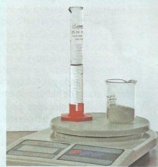
Medida da massa inicial do sistema em que proveta e bquer contêm, respectivamente, bicarbonato de sódio e vinagre.
