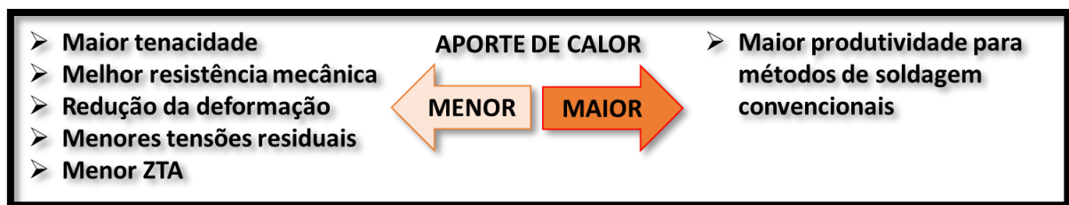
Figura 13: Efeito do aporte de calor em junta soldada.
