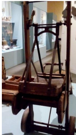
Figura 20 - Descaroador de Algodão em madeira e metal -maquinário do acervo do Museu Afro Brasil- São Paulo/SP. Fonte: acervo próprio.
