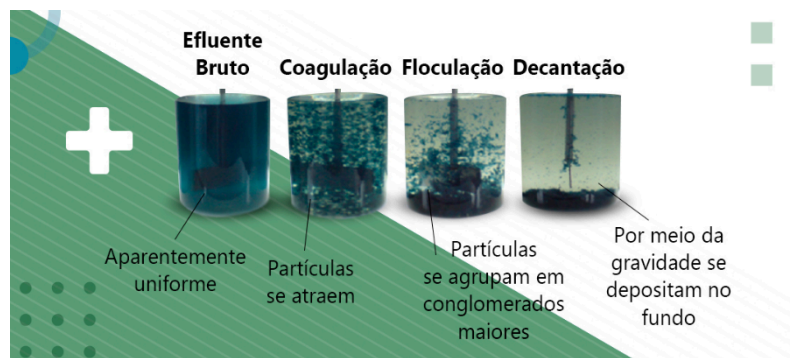
Figura 5: Etapas de coagulação, floculação e decantação.
