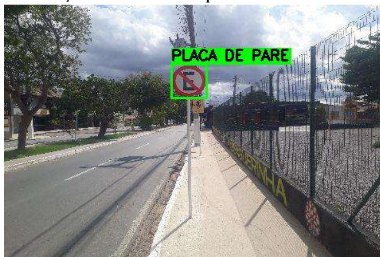
Figura 37 – Falha na identificação da classe correta da placa de trânsito
