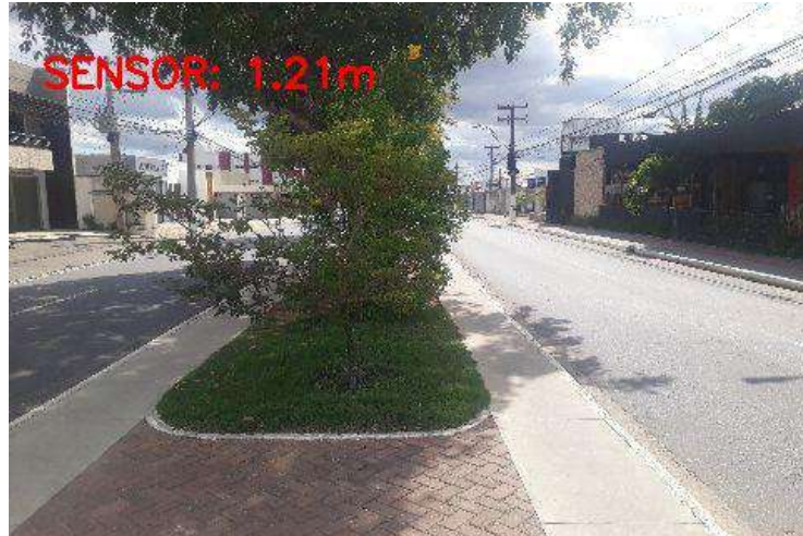
Figura 36 – Falha na classificação visual da árvore e aplicação da redundância
