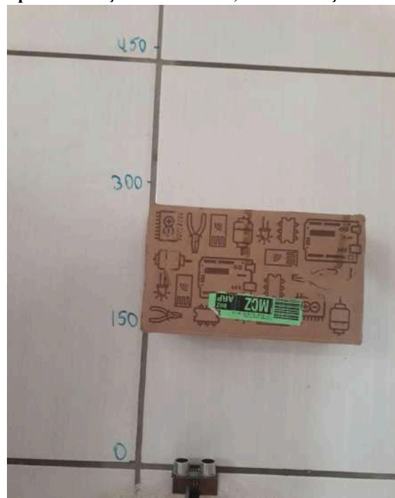
Figura 28 – Bancada de teste para validação de distância, com marcações a cada 15 cm (150mm)
