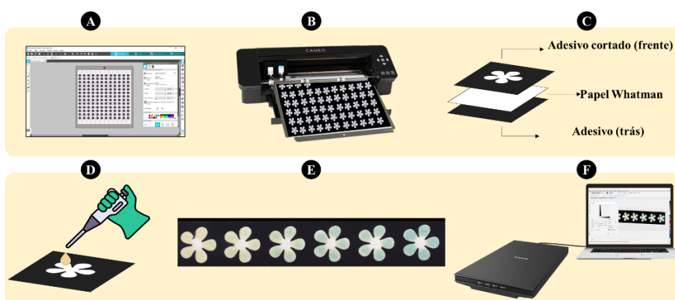
Figura 14 – Etapas de elaboração do dispositivo: (A) layout desenhado em Silhouette Studio , (B) corte do papel adesivo em Silhouette Cameo 4 , (C) montagem, (D) adição dos reagentes, (E) dispositivo após adição dos reagentes e enzima, (F) obtenção das imagens com scanner e análise.
