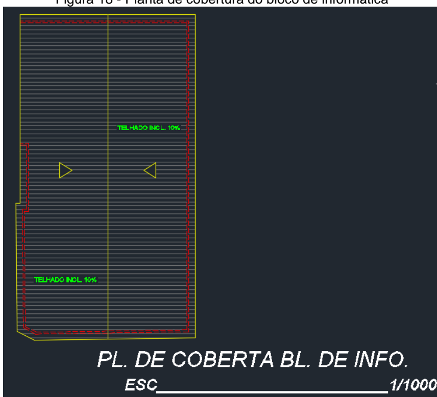
Figura 18 - Planta de cobertura do bloco de informática
