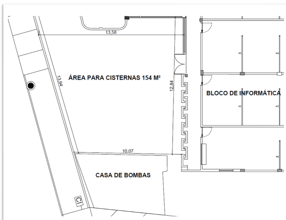
Figura 19 - Área de locação do reservatório
