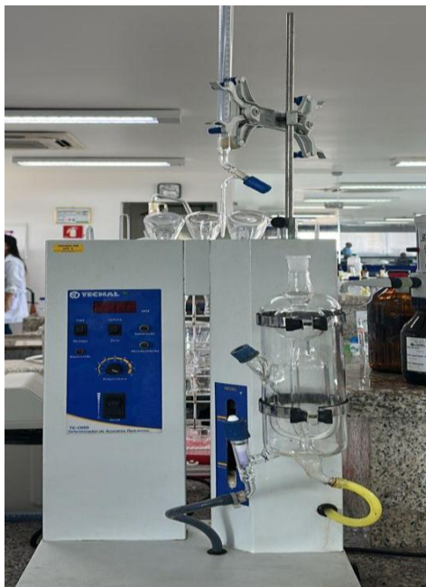
Figura 6 – Método de titulação de Lane-Eynon utilizando um redutec.
