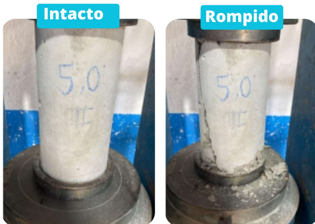
Figura 17 – Rompimento dos corpos de prova durante ensaio de resistência à compressão
