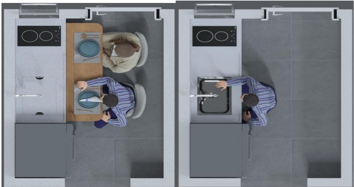
Figura 26: Planta de layout , mostrando a mesa retrátil aberta (à esquerda) e fechada (à direita).
