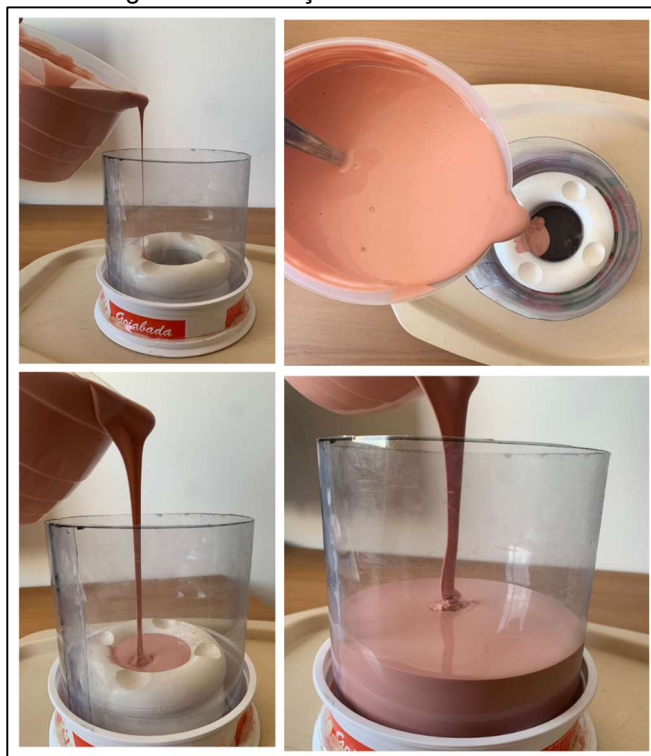
Figura 24: Produção do molde da base
