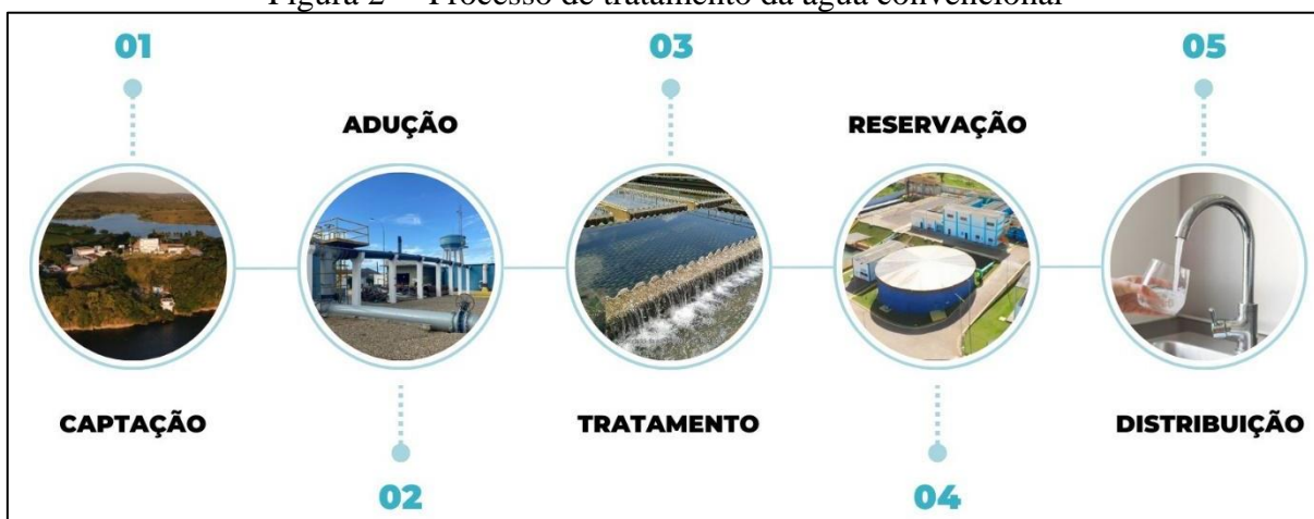
Figura 2 – Processo de tratamento da água convencional
