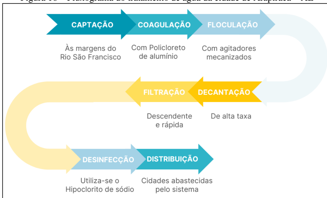
Figura 16 – Fluxograma do tratamento de água da cidade de Arapiraca – AL
