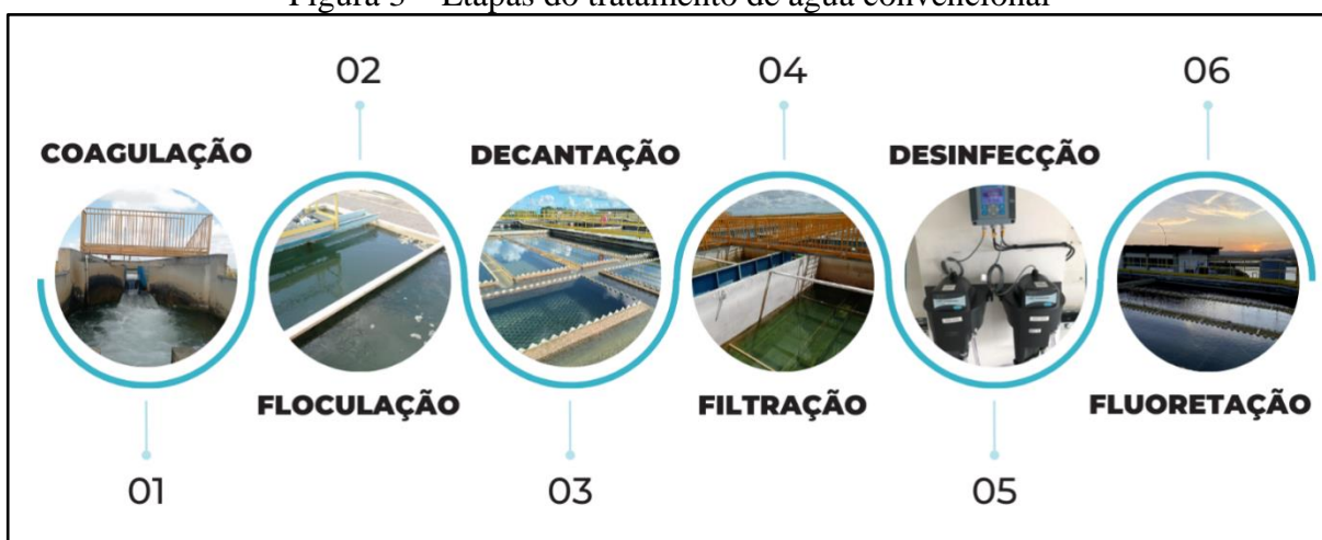
Figura 3 – Etapas do tratamento de água convencional
