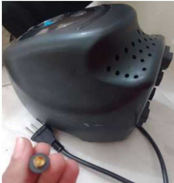
Figura 12 - Troca de fusível
