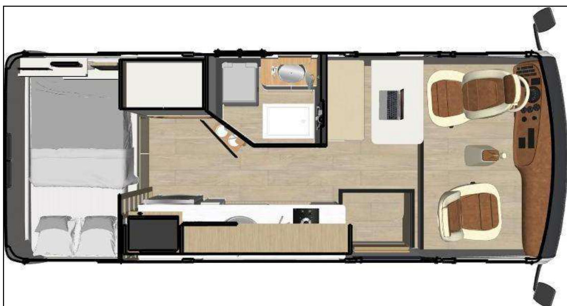
Figura 39- Planta baixa proposta 03 – layout final.
