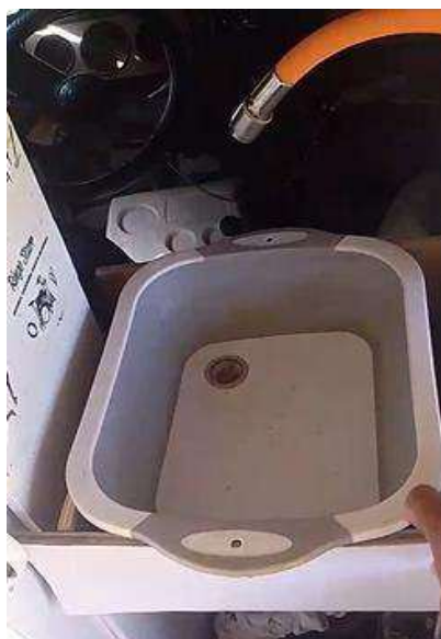
Figura 17 - Bancada com estrutura removível e pia retrátil
