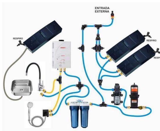
Figura 12 - Esquema hidráulico de um motorhome
