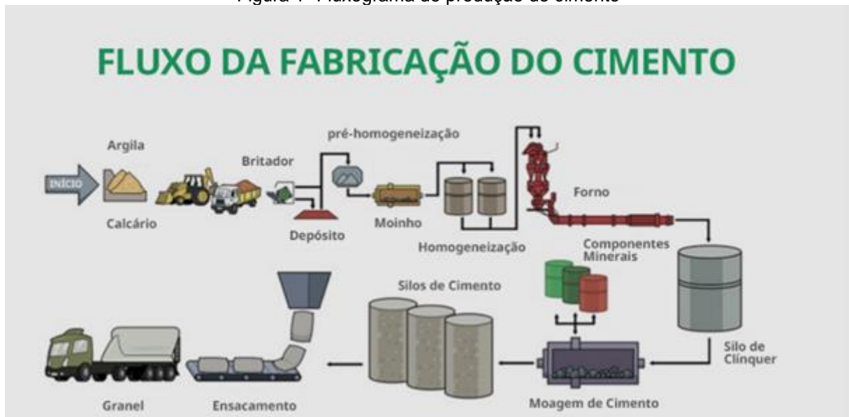
Figura 1- Fluxograma de produção do cimento
