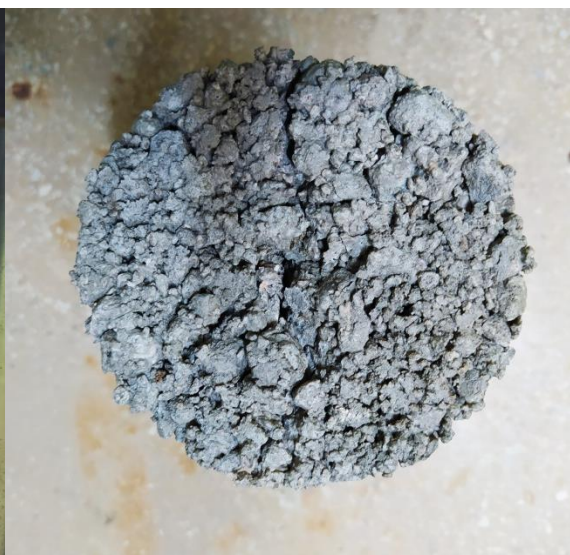
b) Corpo de prova rompido
