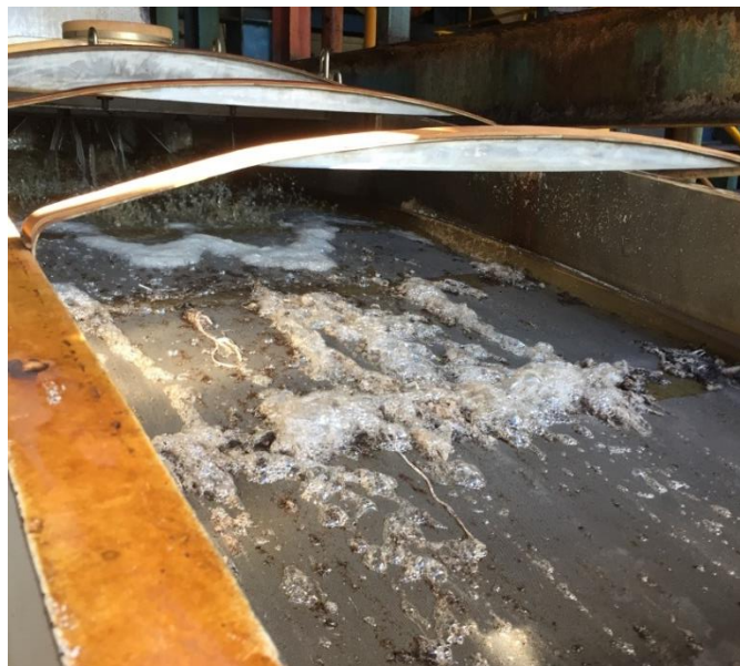
Figura 4: Peneiramento do licor e remoção das impurezas.
