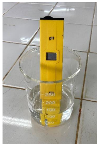
Figura 7: Medidor de pH com eletrodo inserido na amostra de água. Fonte: Autor, 2023.
