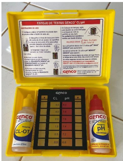
Figura 8: Medidor de Cloro e pH. Fonte: Autor 2023.
