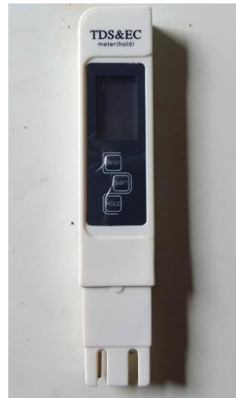
Figura 11: eletrodo do medidor pelo qual deve ficar imerso sob a água. Fonte: Autor, 2023.
