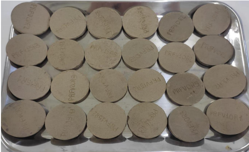
Figura 24 - Corpos de prova a verde após a moldagem
