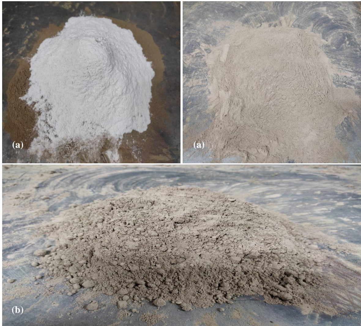
Figura 23 - (a) Homogeneização dos constituintes secos e (b) úmidos da massa a verde
