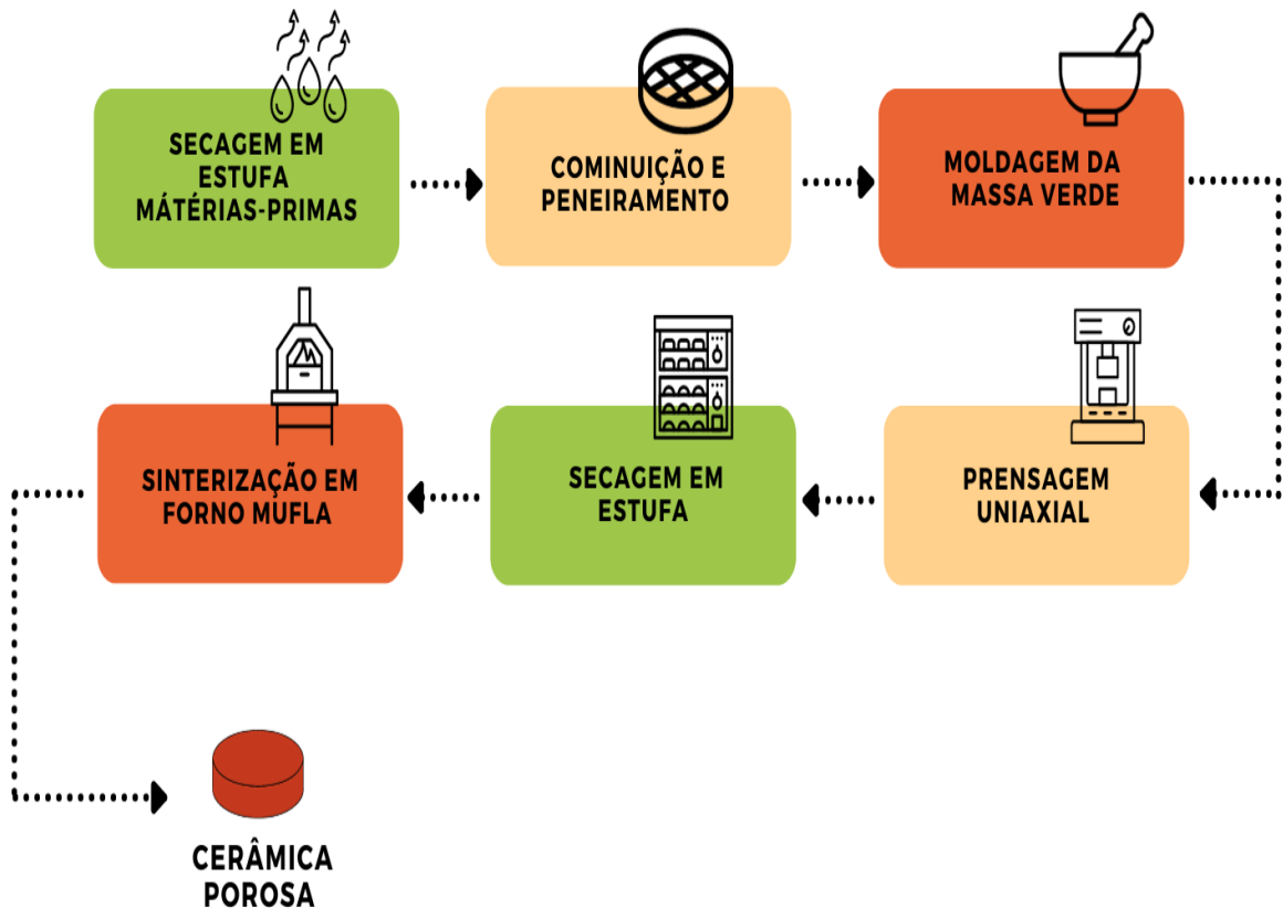
Figura 22 - Fluxograma de obtenção dos corpos de prova
