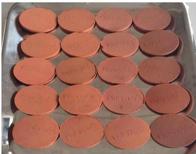
Fig. 4. Corpos de prova sinterizados prontos para a realização dos ensaios tecnológicos
