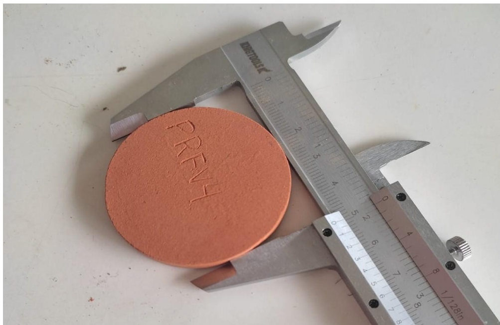
Figura 27 - Utilização de paquímetro para medição dos diâmetros dos corpos de prova
