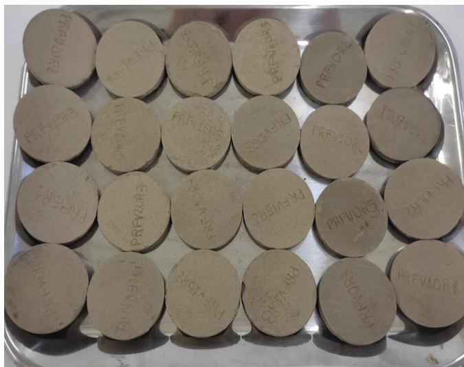
Fig. 3. Corpos de prova a verde após a moldagem
