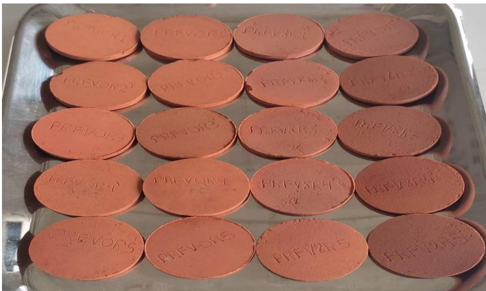
Figura 26 - Corpos de prova sinterizados prontos para a realização dos ensaios tecnológicos
