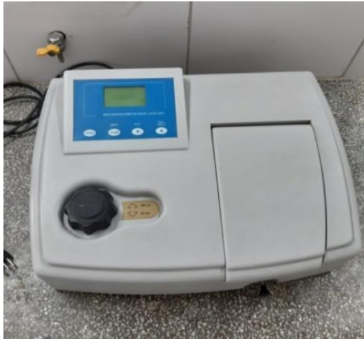
Figura 8 - Espectrofotômetro utilizado, modelo Nova 2000
