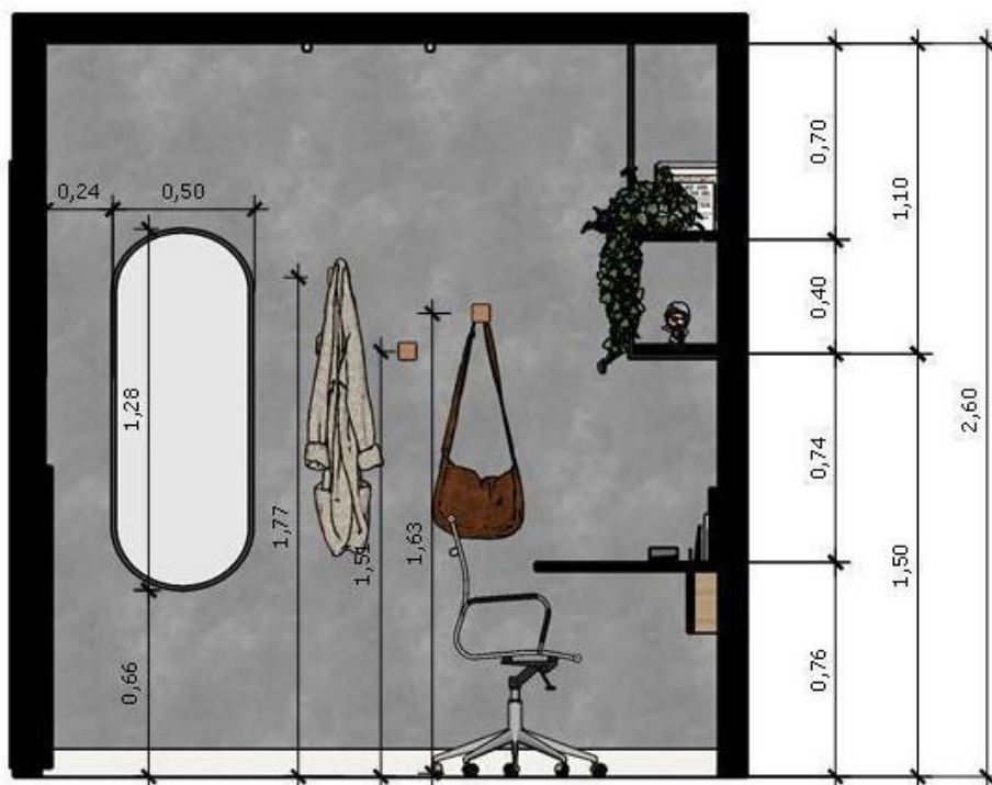
Figura 25: Corte da bancada de trabalho.
