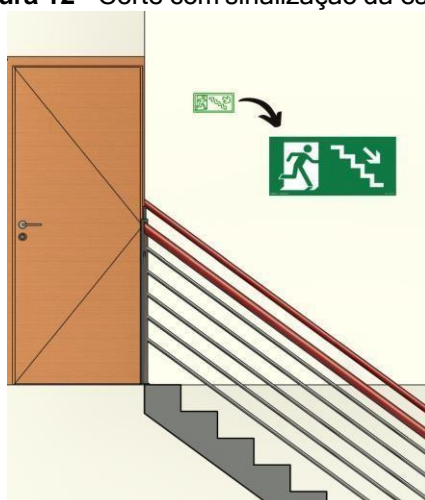
Figura 12 - Corte com sinalização da escada
