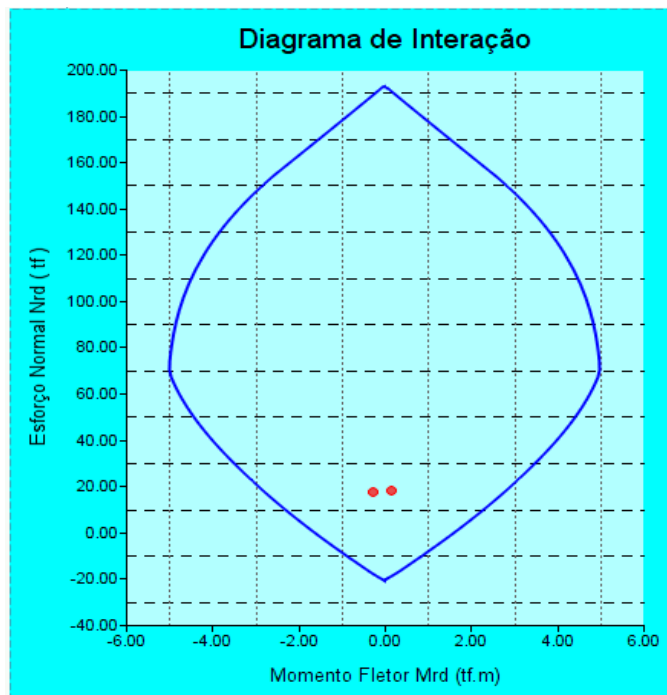
Figura 4.17: Diagrama de interação esforço normal - momento fletor
