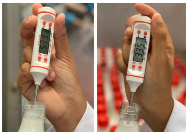
Figura 13. Temperatura de entrada e de saída.
